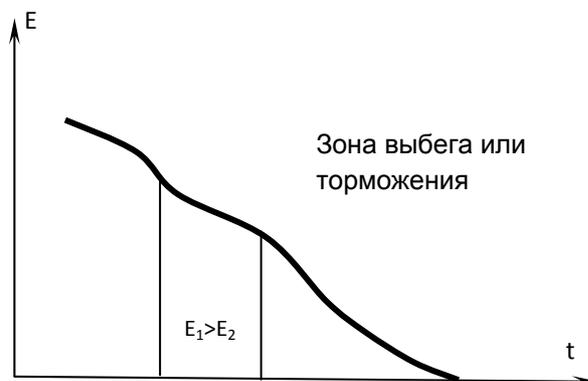
Рис. 2. График движения машины с убывающей живой силой
