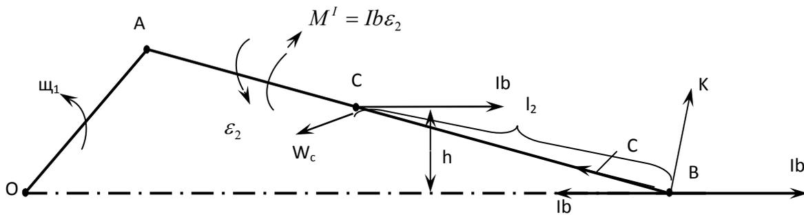
Аналогичное заключение можно сделать и относительно силы К. Сила К перпендикулярна к шатуну, наклоном которого к ОВ при нормальной длине его относительно кривошипа можно пренебречь, поэтому сила К вместе с тем будет примерно перпендикулярна к скорости  $V_B$ , следовательно, почти целиком воспринимается реакцией параллелей.
